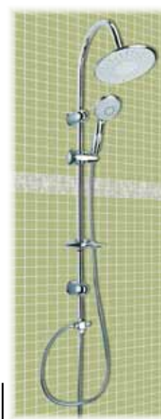
COLONNA DOCCIA in ottone cromato con doccetta anticalcare a 4 getti + pausa, soffione da cm. 20, flessibile in acciaio inox doppia graffatura. Fissaggio a muro regolabile. Cod. 343770
