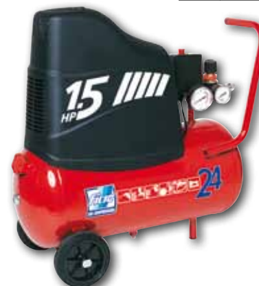
COMPRESSORE CARRELLATO autolubrificato, 24 Lt, potenza motore 1300W, pressione max 8 bar, aria aspirata 160 lt/min Cod. 413166
