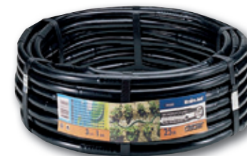
TUBO GOCCIOLANTE in polietilene da 1/2" dotato di gocciolatori interni a labirinto da 2 litri/ora, posizionati ogni 33 cm. Rotolo da mt. 25 Cod. 35843
