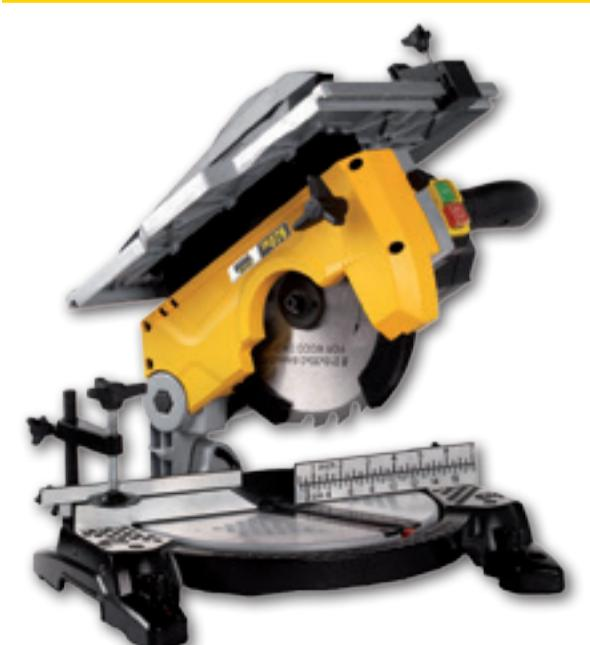
motore 1200W, piano superiore in alluminio rigido e solido, impugnatura e alzata piano regolabile, morsetto verticale, spingilegno, peso 10 kg, 1280244
