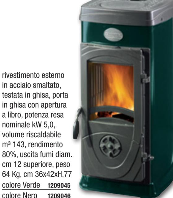
rivestimento esterno in acciaio smaltato, testata in ghisa, porta in ghisa con apertura a libro, potenza resa nominale kW 5,0, volume riscaldabile m<sup>3</sup> 143, rendimento 80%, uscita fumi diam. cm 12 superiore, peso 64 Kg, cm 36x42xH.77
