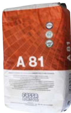
ADESIVO/ RASANTE A 81 Bianco, per blocchi in cemento cellulare, granulometria <0,6 mm, resa teorica come rasante 1,4 kg/m² per 1 mm di spessore, resa teorica come adesivo 5-7 kg/m², 25 kg 22930
