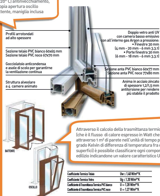
Attraverso il calcolo della trasmittanza termica (che è il flusso di calore espresso in Watt che passa attraverso 1 m<sup>2</sup> di parete nell'unità di tempo per ogni grado Kelvin di differenza di temperatura fra due superfici) è possibile classificare ogni componente edilizio indicandone un valore caratteristico U
