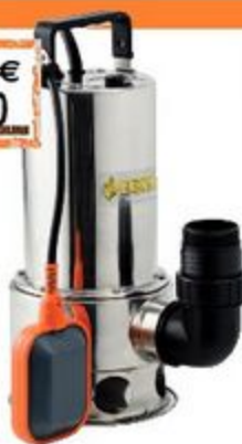
POMPA SOMMERSA SVX1100 EUROMATIC Acciaio inox, 1100W, prevalenza mt 10,5; portata lt/min 280 05179
