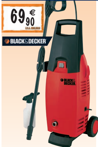
IDROPULTRICE 110 BAR 1400W, 370 Lt/h, pompa a 3 pistoni assiali comandati dal piattello oscillante, valvola di sicurezza automatica con riciclo a bassa pressione, kit aspirazione detergente, filtri acqua, peso Kg 7,8 05121
