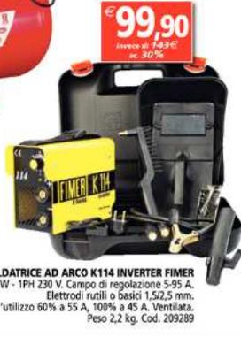
**SALDATRICE AD ARCO K114 INVERTER FIMER**
