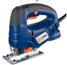
SEGHETTO ALTERNATIVO DEXTER Potenza 570 W. Velocità 0-500 giri/min. Taglio inclinato da 0 a 45°. Profondità di taglio: legno 65 mm, alluminio 12 mm e acciaio 4 mm. Cod. 209907
