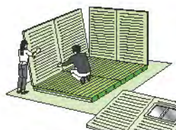
Costruzione a pannelli
