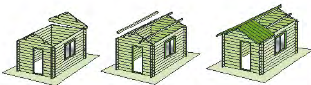
Costruzione ad incastro
