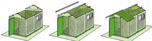
Costruzione a pannelli
