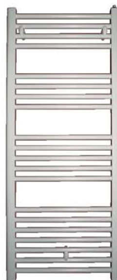
Termoarredo acciaio Elba bianco Ideale per 5 m 2 Dimensioni: L50xH120 cm Interasse: 450 mm Resa termica: 442 Kcal/h, 514 W Peso: 6,9 Kg
