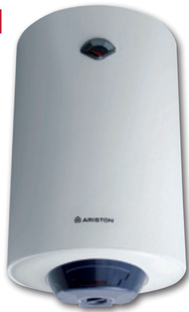
80 lt, potenza 1500 W, termostato di sicurezza, anodo di magnesio, isolamento in poliuretano espanso, tempo di riscaldamento 220 min, elevata quantità acqua calda miscelata, a norma E.R.P. 1274090
