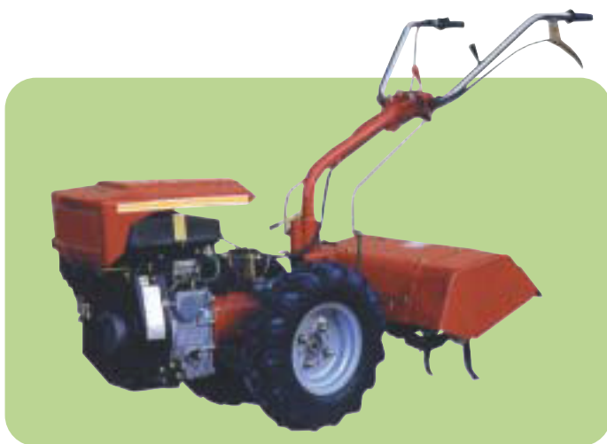
CICO 126 - MOTOCOLTIVATORE cod. 74250-10/3 potenza 8 Hp/4T a benzina, cambio 3 marce + 2 retromarce, fresa registrabile 33-66 cm, peso 123 kg
