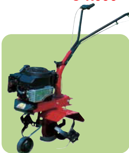
EURO 3 - MOTOZAPPA cod. 72600-10/3 potenza 3,5 Hp/4T a benzina, motore Briggs & Stratton Classic, fresa 40 cm, cambio 1marcia velocità, peso 43 kg
