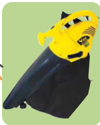
VAS-2200 aspira-soffiatore cod. 71730-10/3 potenza 2200 watt, motore 220 V - 50 Hz, capacità sacco 50 lt, rapporto biotriturazione 1:10
