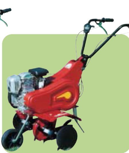
EURO 5 RM - MOTOZAPPA cod. 72660-10/2 potenza 5,5 Hp/4T a benzina, motore Briggs & Stratton INTEK OHK, fresa 80 cm, cambio 1 marcia + retromarcia, peso 55 kg
