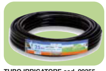
TUBO IRRIGATORE cod. 90355 TUBO GOCCIOLANTE 25 m tubo in polietilene da 1/2" (13 - 16 mm) dotato di gocciolatori interni a labirinto da 2 litri/ora (posizionati ogni 33 cm) che garantiscono una altissima uniformità di erogazione su tutta la superficie coltivata, ridotto fabbisogno d'acqua: pressione di esercizio tra 0,5 e 1 bar, rotolo da 25 m
