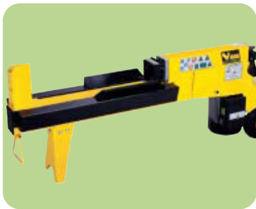
VIGOR LS5T-52 - spaccalegna cod. 65047-10 spinta orizzontale, motore monofase 220 V, kw 1,5, max forza di spinta 5 ton, max lunghezza di taglio 52 cm, peso kg 50 ca.
