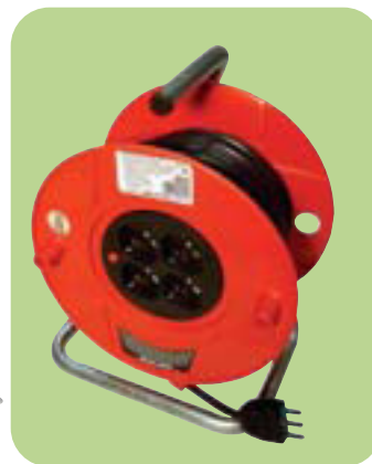
AVVOLGICAVO cod. 709 25 m, cavo H05W-F 3 x 1, 5 mm, spina 16A 2P+T, 2 prese bivalenti 10/16A 2P+T, 2 prese 10-16A 2P+T (italiano 10/16A e tedesco 16A con terra laterale), disgiuntore termico, CE
