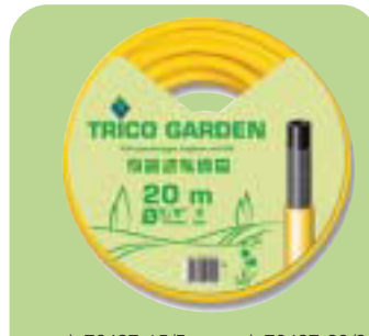
TUBO IN POLIETILENE cod. 90370 TUBO CAPILLARE 20 m tubo da 1/4" (4 - 6 mm) per derivazioni dal tubo collettore, alimenta i gocciolatori in linea e fine linea, flessibile, antialghe, resiste alle basse temperature e ai raggi del sole, rotolo da 20 m
