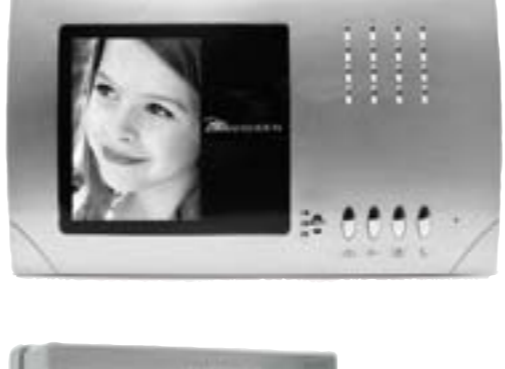
Videocitofono modulare 4 fili mani libere con schermo b/n 4", pulsante apertura serratura e cancello elettrico, videocamera a infrarossi per visione notturna, possibilità di collegare 1 telecamera filare b/n
