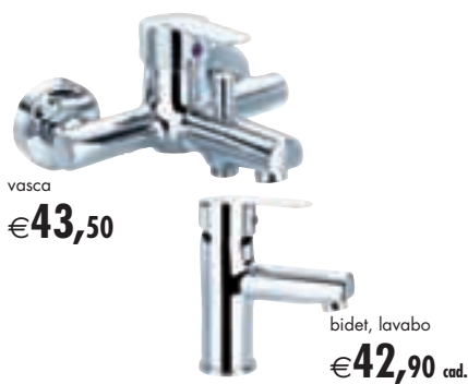
Mix Tom , lavabo, bidet e vasca, corpo interamente in ottone, cartuccia a dischi ceramici ø40, dove previsti coppia attacchi inox 3/8" F lunghezza 35 cm, completo di scarico automatico in ottone da 1"1/4"
