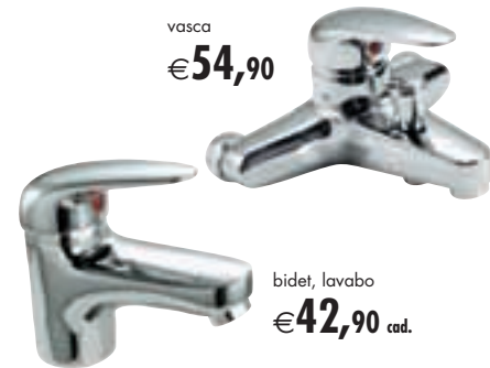
Mix Mega , lavabo, bidet e vasca corpo in ottone cartuccia ø40, attacchi 3/8" F 35 cm, completo di scarico in ottone da 1"1/4"
